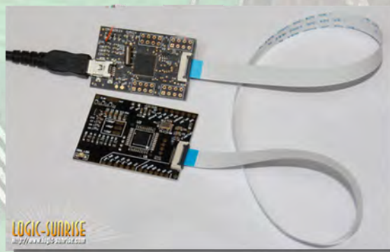
connectez le câble plat 15 broches FCC du SQUIRT BGA au PROGRAMMEUR comme sur l'image. Vous aurez un accès facile à la programmation du JTAG XILINX et SPI ! Plug and Play sans soudure !
